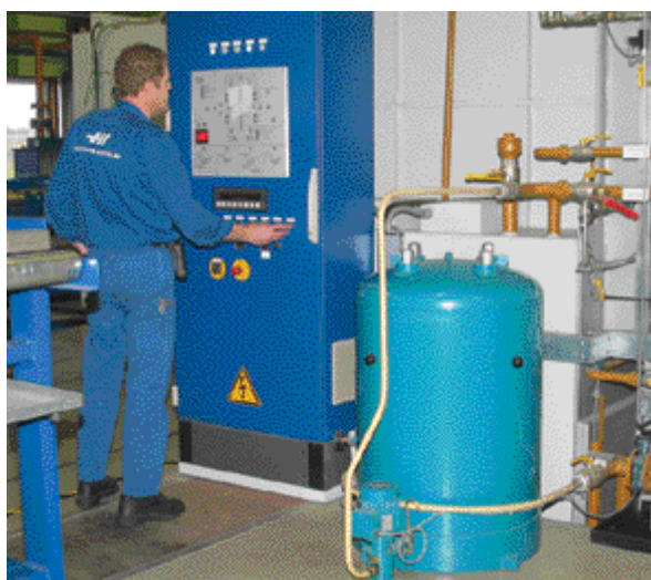
Hærdemester Jan Sund ved siden af det store in-line filter, der sikrer at emner kun skal vaskes efter hærkning.
