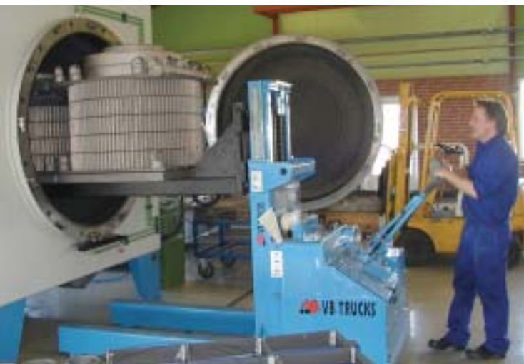
Johmy fra nitrerafdelingen fylder en charge i den store nitrerovn, som har forbedret vores leveringstider, samt hævet grænsen for emne-dimensionerne der kan nitreres i ovnen, der er Ø 1380 x 1800 mm.
