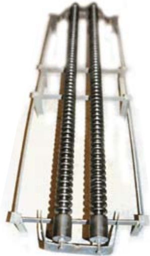
Trådførere til tekstilmaskine med K-Tech belægning.
